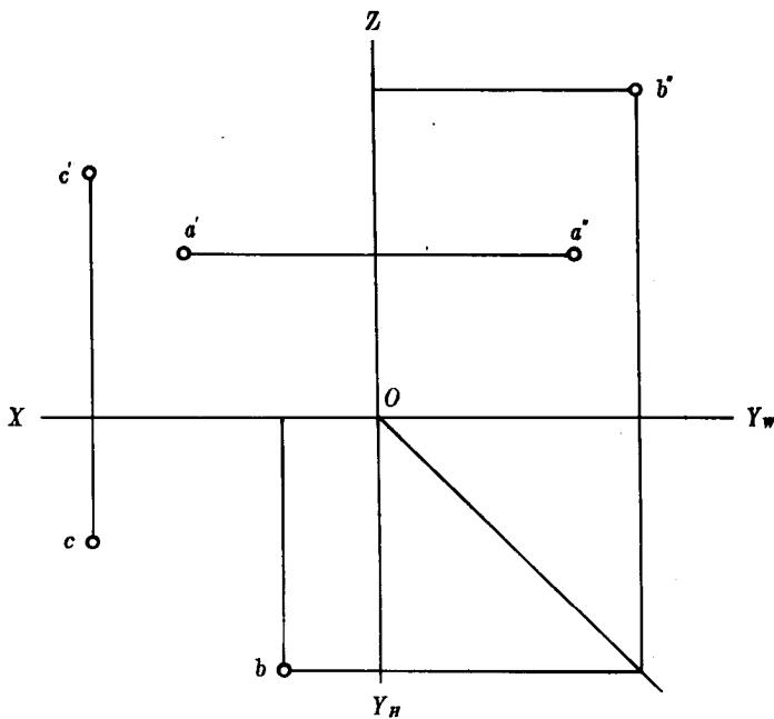
2. 已知点 B 在点 A 的左边 20mm，在点 A 前方 10mm，比点 A 高 15mm，试作出点 B 的三面投影图。
