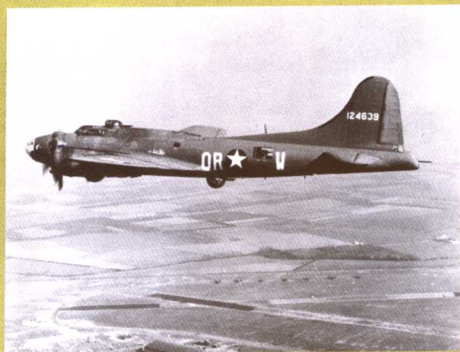
早期的B-17，可以看到还没有安装机腹炮塔
