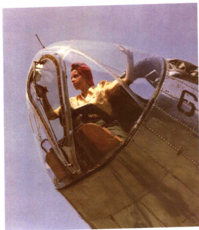
由完全透明玻璃装配而成的机头
