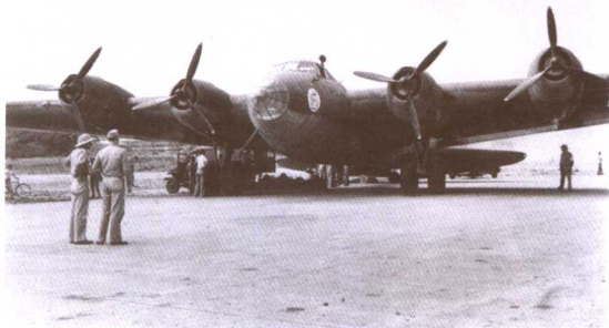
波音公司研制的XB-15轰炸机，这是美国人最早尝试设计的四发重型轰炸机，它为日后的B-17打下了良好的基础
