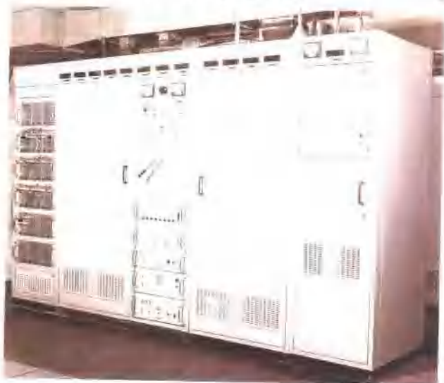
1972年北京广播器材厂研制的我国第一部特大功率1000千瓦短波广播发射机
