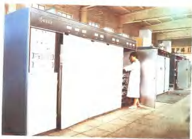
北京广播器材厂TVU411型分米波10千瓦外腔速调管彩色电视发射机生产装配现场
