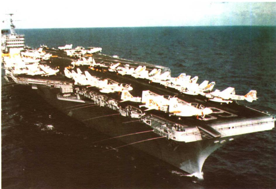
“艾森豪威尔”号航空母舰1977年10月18日编入大西洋舰队服役，母港为诺福克，其舰载航空兵为第7舰载机联队。该母舰的主要攻防武器是80余架各型舰载机，除此之外，还装备有导弹和火炮武器。导弹武器主要有3座八联装MK29型北约“海麻雀”对空导弹发射装置，该型导弹用半主动雷达寻的，射程14.6千米，速度2.5马赫。在“尼米兹”号和“艾森豪威尔”号上，装有3座MK15型“火神”“密集阵”6管20毫米口径近防武器系统，在“卡尔·文森”及其后续舰上，则装有4管MK15型“火神”/“密集阵”近防武器系统。其射速为3000发/分，射程1.5千米。
