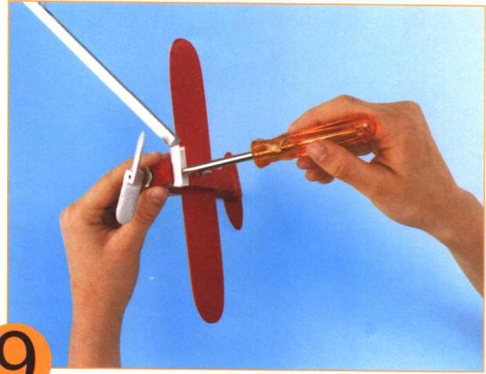
在U型铝条钻孔的一端锯一个断口，螺丝穿过铝条上的小孔将飞机固定在上面。用环首螺丝固定飞机后部，螺丝环形部分可以假想为飞机轮子。
