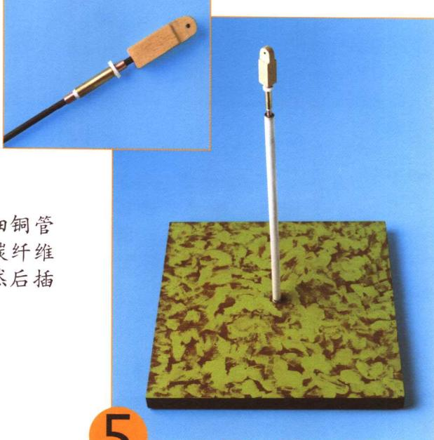
将塑料垫圈套在细铜管上，再把细铜管套在碳纤维棒上，贴靠于支架边。把碳纤维棒另一头磨尖，先套一个金属垫圈，然后插到塞在底座中密度板里的塑料管中。
