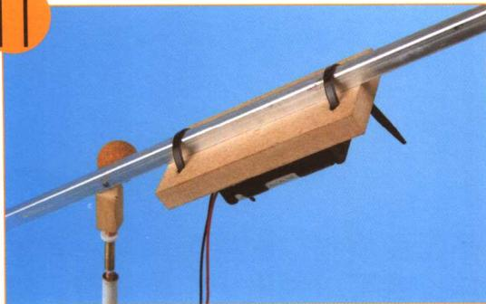
用螺丝把电池盒固定在其底座上，放入电池。把法兰从底座小孔穿入，用法兰把电池盒底座固定在U型铝条上，法兰方向与飞机前行方向相反。
