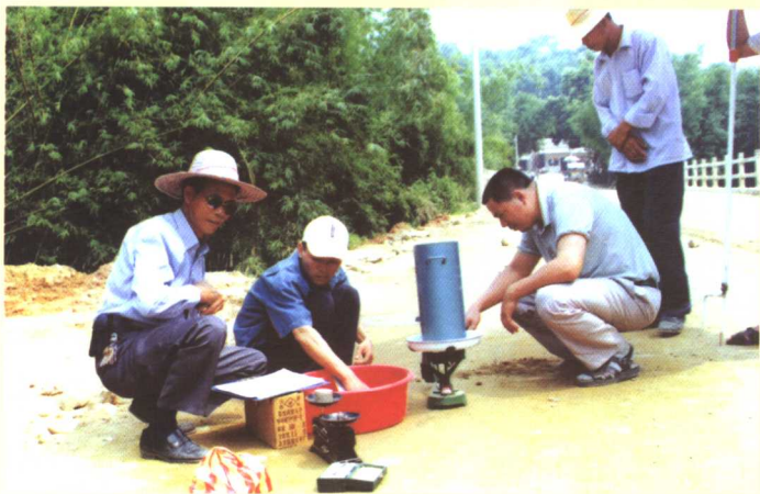
2001年8月， 珠木线公路改 造，公路建设 指挥部质监组 会同施工队检 测基层压实度。
