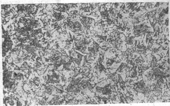
圖 7. 不完全淬火鋼的組織——馬氏体十純鉄体(白色)
