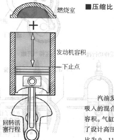
汽油发动机的混合气压缩比越高，输出功率也越大。吸入的混合气体积为气缸和燃烧室的总容积，也就是气缸容积。气缸容积与燃烧室容积的比值称为压缩比。因此为了设计高压缩比的发动机，同时还要防止爆燃，一般压缩比为9~11之间。
