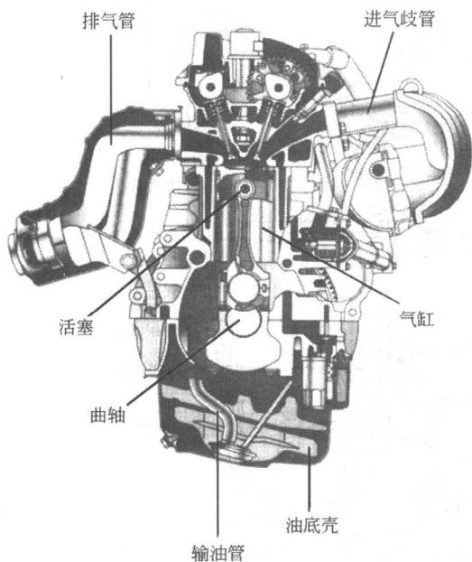
从上面开始依次为气缸盖、气缸体、油底壳。气缸盖和气缸体之间包含了曲柄连杆机构。在上图的运动部件中，活塞、连杆和曲轴是通过油底壳的润滑油进行润滑的。输油管的作用是从油底壳中向其他运动部件输送润滑油。
