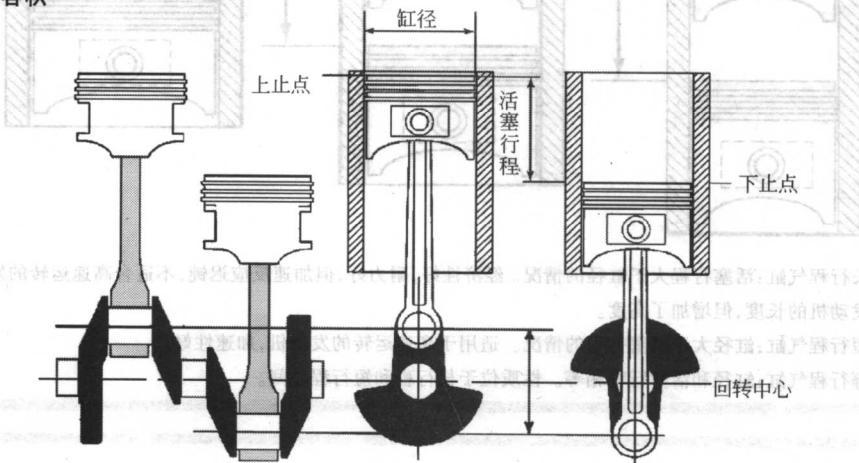
缸径×活塞行程的单位是cc或L。这只是1个气缸的容积。比如汽车的1个气缸容积为1000cc，那么4个气缸或6个气缸的容积分别为4000cc或6000cc。但实际上是有误差的，1个气缸容积大约为996cc。
