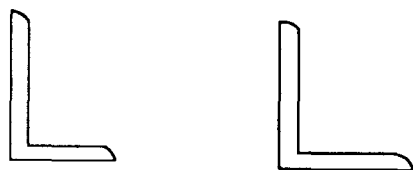
图 1-1-6 角钢外形形状示意
