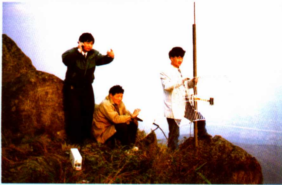
福建数字遥测地震台网中心技术人员在调试数字扩频微波信道
