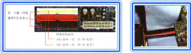
第一块硬盘连接第一组 IDE 插座，光驱接至第二组 IDE 插座。
