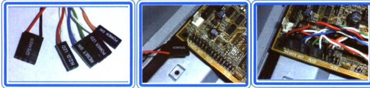
请参考主板说明书，主机机箱前面板控制电源线接头插入，将电源线连接至相关接脚。
