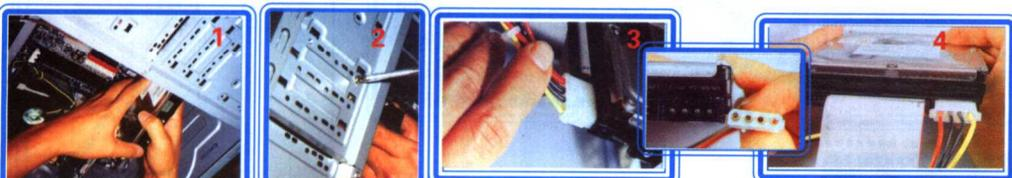
1. 将硬盘装置推入导槽内。2. 对准硬盘即与导槽的孔位, 上好螺丝。3. 将电源供应插头插至硬盘电源插座。4. 将 40 或 80pin 的数据线对准插入硬盘。
