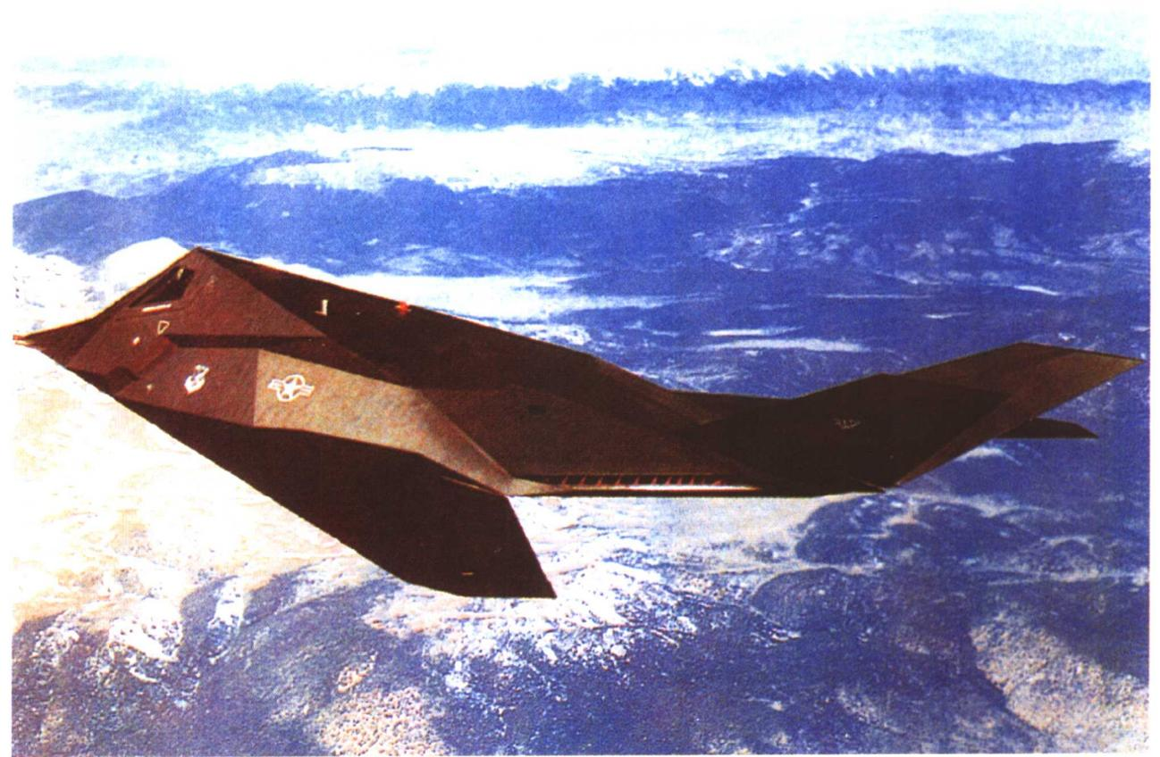
**美国 F-117 隐身战斗机** 具有很好的雷达、红外和目视隐身能力。除主要用于压制敌方防空系统，摧毁严密设防的指挥所、战略要地、核生化中心、重要工业目标外，还可执行侦察任务，并且有一定的空战能力。在1989年美国入侵巴拿马的军事行动中，F-117A首次参加实战。海湾战争中，有42架F-117A参战，出动了近1 300架次，虽然仅占这次战争中总轰炸架次的2%，然而却轰炸了目标清单中40%以上的目标。其机长20.08米，翼展13.2米，机高3.78米，最大起飞重量23 814千克，最大速度0.9马赫，作战半径1 112千米，所有武器均装在内部弹舱里，可携带美国空军战术战斗机的各种军械。发射导弹时，内部挂架可伸出舱外。
