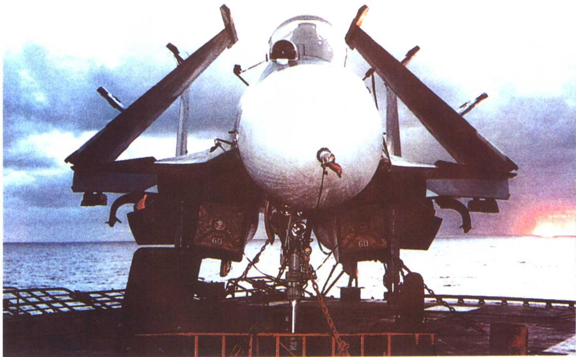
**俄罗斯苏-33战斗机** 主要搭载在俄“库兹涅佐夫”号航空母舰上。该机翼展7.4~14.7米，总长21.94米，总高5.93米，最大起飞重量22 500千克，最大飞行速度2.25马赫，实用升限15 000米，航程3 000千米。机上可携带10枚空空导弹。
