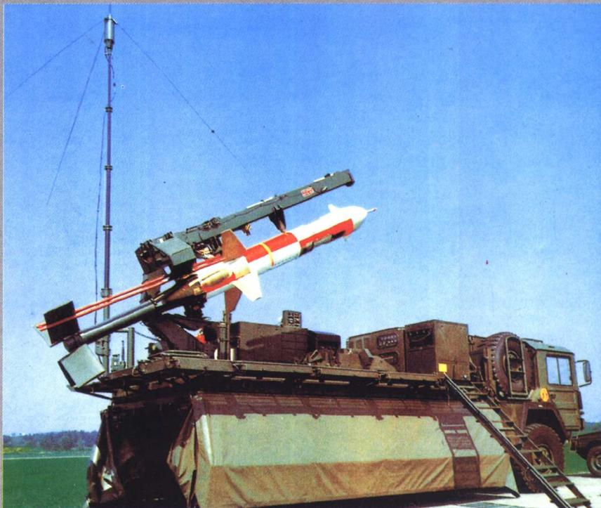
英国“不死鸟”无人侦察机 主要用于战场侦察、监视与目标捕获。全重175千克，有效载荷50千米，飞行速度155千米/小时，实用升限2750米，续航时间4小时。
