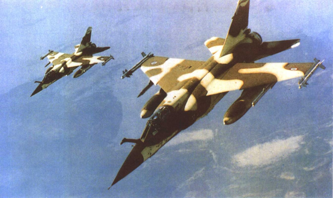
**法国“幻影”F-1战斗机** 1973年正式服役，配备不同的武器和设备，可完成制空、截击、低空对地攻击等任务。翼展8.4米，机长15.30米，机高4.5米，最大起飞重量16200千克，最大平飞速度2.2马赫，实用升限20000米，作战半径425千米，续航时间3小时45分。装备2门30毫米机炮；外挂点最大载弹量6300千克；执行截击任务时外挂“响尾蛇”或“马特拉”空空导弹；执行对地攻击任务时外挂反雷达导弹、反舰导弹、普通炸弹、跑道穿破炸弹和火箭。
