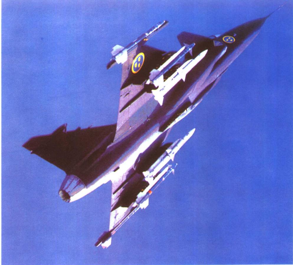
**瑞典 Saab-37 “雷” 多用途战斗机** 是瑞典 60 年代研制的全天候多用途战斗机，主要用于低空超音速突防和对地攻击，进行空中截击及低空侦察和教练，具有短距起落能力，可使用长约 500 米的公路作为跑道。翼展 10.6 米，机长 16.4 米，机高 5.9 米，最大起飞重量 17 000 千克，最大平飞速度 2 马赫，实用升限 18 500 米，作战半径 1 500 千米。装 1 门 30 毫米机炮；机身下有 3 个外挂点，机翼下有 4 个外挂点，外挂武器为 2 枚“天空闪光”和 6 枚“响尾蛇”空空导弹，对地攻击时可携带 24 枚 135 毫米火箭弹。
