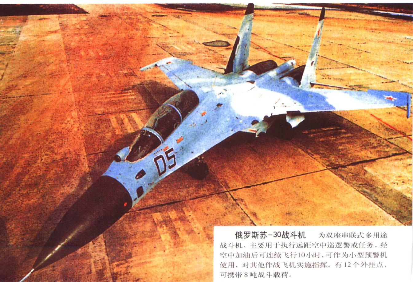
**俄罗斯苏-30战斗机** 为双座串联式多用途战斗机，主要用于执行远距空中巡逻警戒任务，经空中加油后可连续飞行10小时，可作为小型预警机使用，对其他作战飞机实施指挥。有12个外挂点，可携带8吨战斗载荷。
