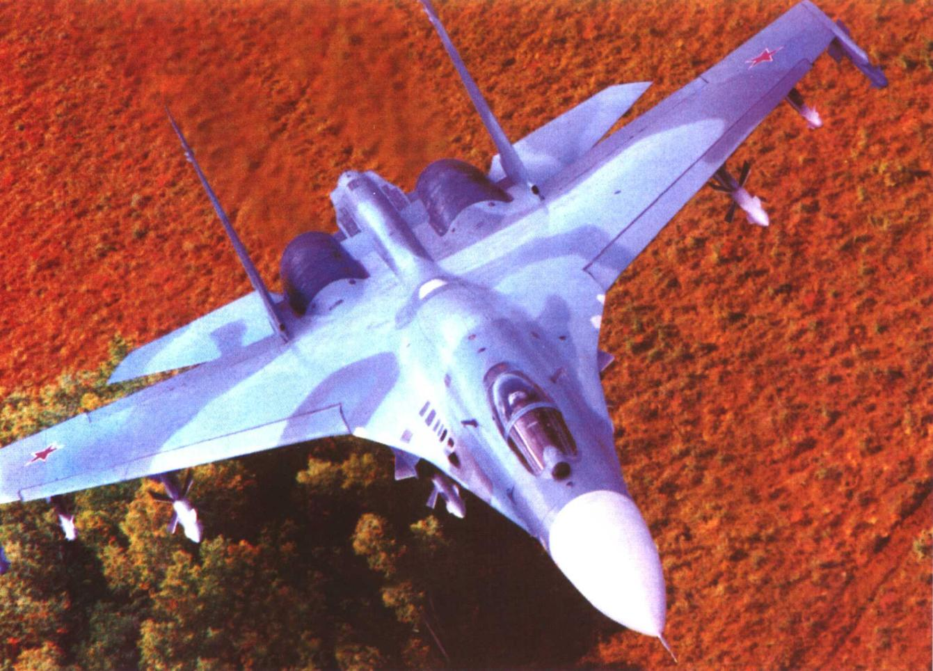
**俄罗斯米格-27“侧卫”战斗机** 属双发重型长续航力制空战斗机，1984年开始服役，具有优异的飞行性能，在攻角 $110^{\circ} \sim 120^{\circ}$ 时仍可保持平稳和可恢复状态，无任何横向发散迹象。其机长21.93米，翼展14.7米，机高5.93米，最大起飞重量33 000千克，最大平飞速度2.36马赫，作战半径1 500千米，实用升限18 500米。曾两次来中国作高难飞行表演，给观众留下难忘的印象。装备1门30毫米机炮；可挂10枚导弹，执行对地攻击任务时带130毫米5发火箭发射器，机尾底部装3个箔条/干扰条投放器。
