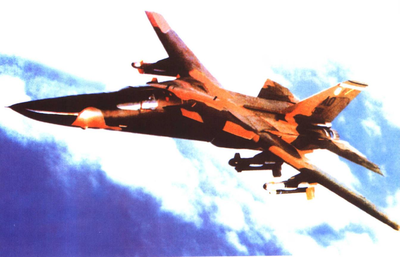
**美国F-111多用途战斗机** 是美国通用动力公司研制的双座双发多用途战斗机，也是世界上第一种实用型变后掠翼战斗机，主要用于夜间、复杂气象条件下执行常规和核攻击任务。由于采用了变后掠翼，更适合低空飞行，实施对地攻击，全天候作战。该机共有9个型别，已生产486架，除美军外，澳大利亚也装备该机。海湾战争中，该机是美空军对伊实施纵深攻击的主力机种。其中，F-111E机长22.4米，翼展9.74~19.2米，高5.22米，最大起飞重量45359千克，最大平飞速度2.2马赫，作战半径1100~2100千米，实用升限14400米。机上装1门20毫米六管机炮；8个挂点，可挂6枚空空导弹，弹舱可带炸弹、核弹。
