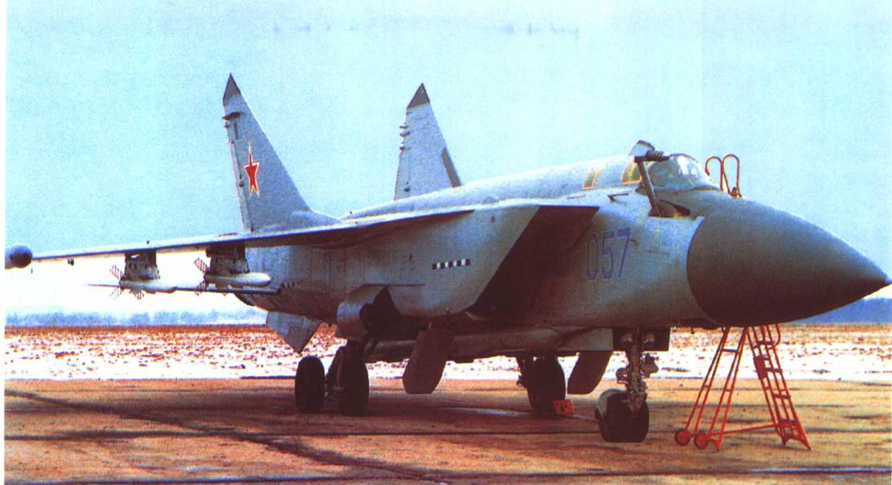
**俄罗斯米格-31“捕狐犬”截击战斗机** 该机是在米格-25基础上发展而成的双座双发全天候截击机，1975年9月开始试飞，1980年服役。该机具有下视、下射能力，航程远，能执行各种作战任务，其火控系统可同时跟踪10个目标，并攻击其中的4个，适合于低空超音速飞行，具有截击包括巡航导弹在内的各种入侵目标的能力。由4架米格-31组成的编队可控制前线800~900千米长的空域。该机机长22.69米，翼展13.46米，机高6.15米，最大起飞重量44000千克，最大平飞速度2.8马赫，作战半径720~1400千米。装备1门23毫米六管机炮；8个挂架可挂8枚空对空导弹。
