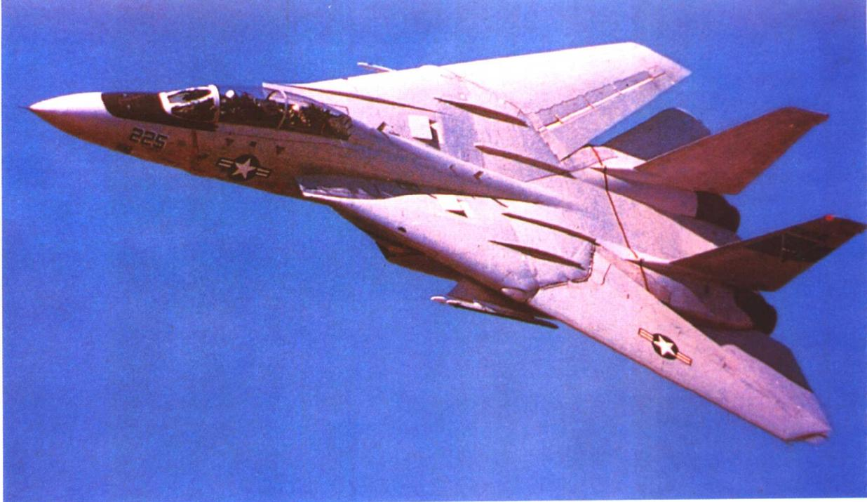
**美国F-14“雄猫”战斗机** 尽管已服役20年，但至今仍是世界上最先进的重型战斗机之一，主要用于舰队防空和海上制空。其机载雷达可截获120~153千米范围内的空中目标；还可以同时对超低空至30000米高度的24个目标进行跟踪，并同时攻击其中6个目标。该机机长19.1米，翼展10.15~19.54米，机高4.88米，最大起飞重量33724千克，最大速度为2.34马赫，最小起飞距离427米，最小着陆距离884米，最大航程3220千米，实用升限16150米。可挂6枚“不死鸟”远程空空导弹和2枚“响尾蛇”近距空空导弹；或4枚“麻雀”中距空空导弹和4枚“响尾蛇”近距空空导弹。
