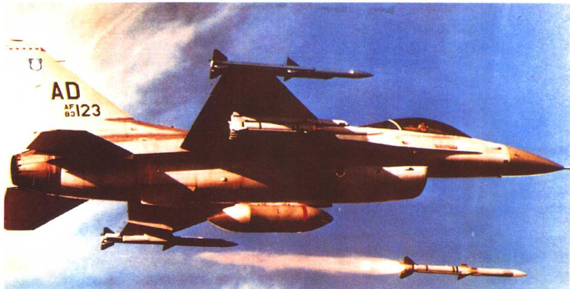
**美国 F-16 “战隼” 战斗机** 是美国通用动力公司为美空军研制的单发单座轻型战斗机，主要用于空战，也可用于近距离空中支援，是美国空军的主力机种。该机机长 15.3 米，翼展 9.45 米，机高 5.09 米，最大平飞速度 2 马赫，实用升限 17 200 米，作战半径 370 ~ 1 320 千米。其生产线将延续到 2000 年，生产总数 4 000 架以上。机上装备 1 门 20 毫米六管机炮；9 个挂点，可挂 6 枚“响尾蛇”近距离空空导弹，或 2 枚“麻雀”中距空空导弹和“幼畜”空地导弹、反辐射导弹和炸弹，载弹量达 5 943 千克。在以色列入侵黎巴嫩的战斗中，该机击落了 85 架米格飞机，一度名声大振。
