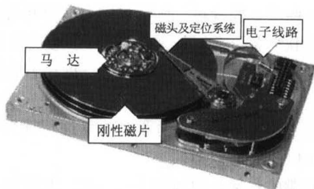
图 1-12 硬盘的内部结构
