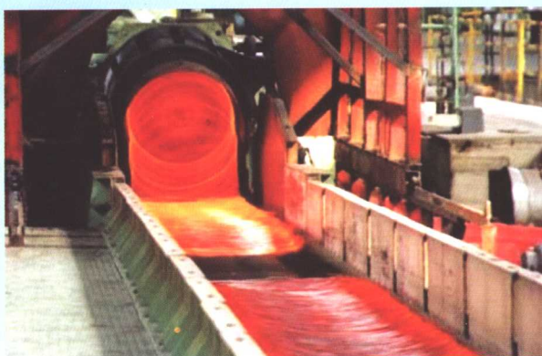
高速线材生产线: 精轧机约 90m/s 最高轧线 105m/s
