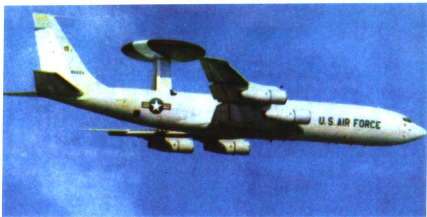
↑ 美国空军的“望楼”雷达预警机，能探测跟踪1000多架飞机
