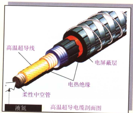
超导电缆结构示意图
