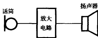
图 1.1-2 半导体扩音器原理示意图
