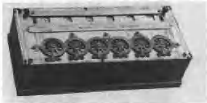
图 1-1 1642 年法国人发明的第一台机械计算机
