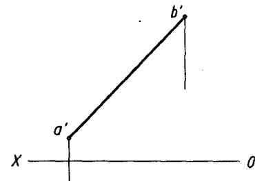
4. 已知水平线  $AB$  上点  $A$  的两投影  $a'$  和  $a''$ ， $AB=20$ ，点  $B$  距  $V$  面 20，且点  $B$  位于点  $A$  的右方，求  $AB$  的三面投影。
