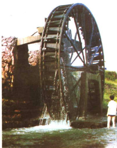
提水机械——筒车（水轮车）
