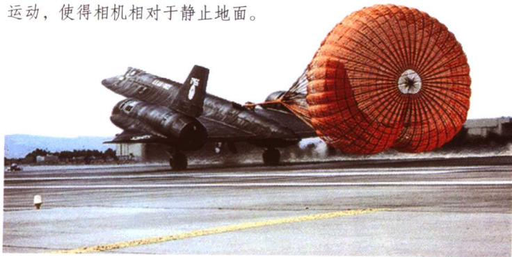
SR-71 在降落时会放出了一朵巨大的橙色减速伞，以缩短降落距离。
