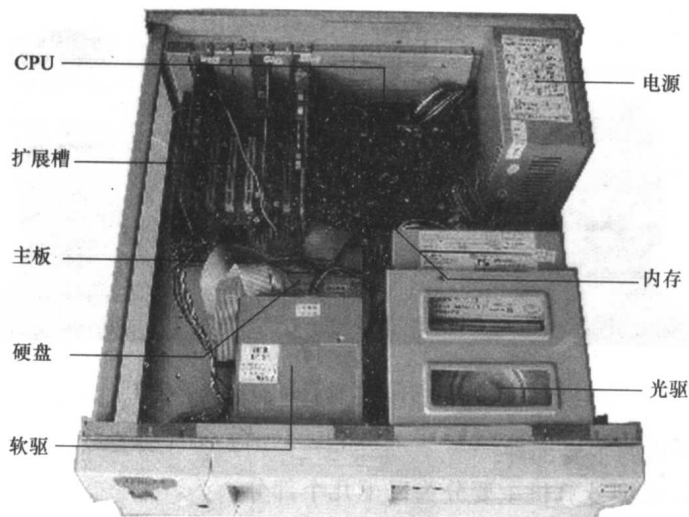
图 1-2 卧式微型计算机主机的内部结构
