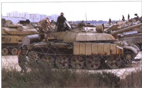
伊拉克 T-55 在炮塔和车体上均安装了附加装甲。
