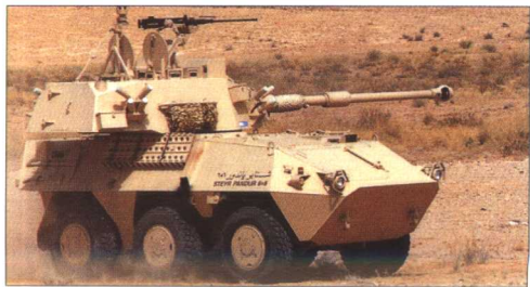
6×6 驱动车型可采用多种炮塔。“游骑兵”的侦察车型安装了的双人 90mm 炮塔。
