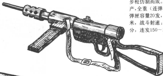
法式柏格门冲锋枪（手提 机枪） 中国仿造，口径7.65 毫米，枪长820毫米，重4.33公 斤，弹匣容量50发（有的25发）， 表尺射程50~100米。
