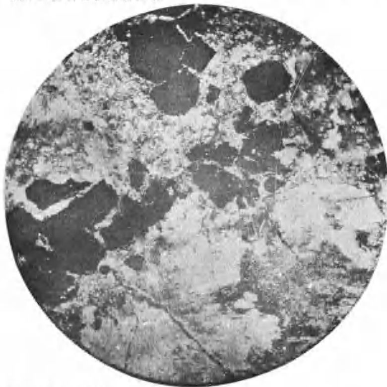
第二圖 同上(放大六十倍) 表示磁鐵礦之晶形與其碎裂纖維狀之石英(或夾長石)甚多。
