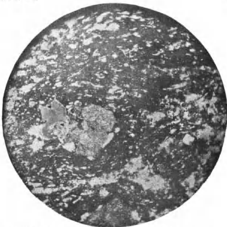
第一圖 鄂城雞子山之流紋岩(放大八十倍)(正交偏光鏡之下) 表示非晶質與石英隱晶質之互層,環繞長石斑晶而成流紋狀.
