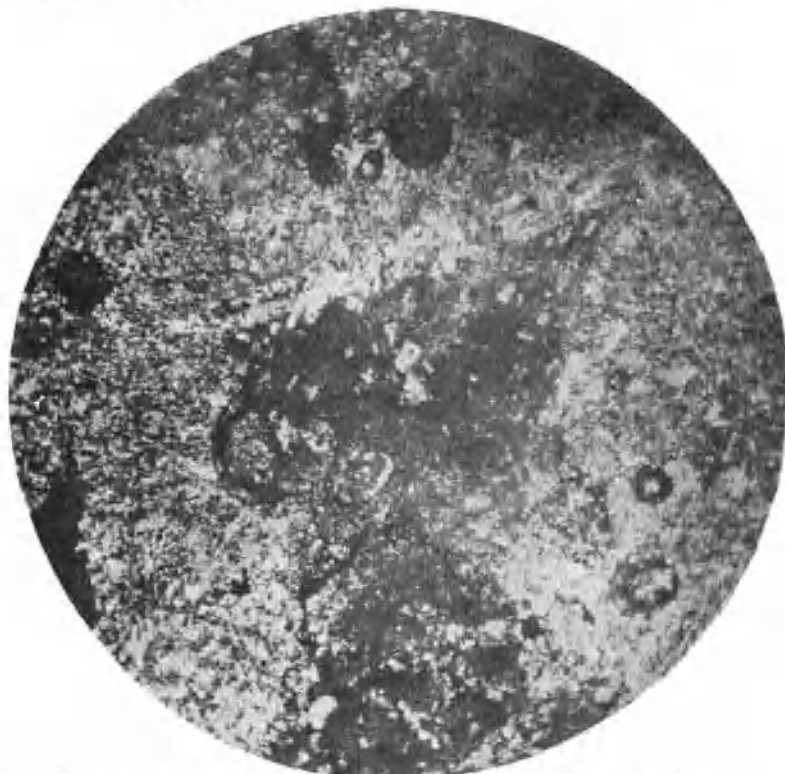
第二圖 鄂城下野山之長英凝灰岩(放大八十倍)(正交偏光鏡之下) 石英晶體發育于石基之間,并向雙方伸張,爲石屑經過磨化與結晶之明證。
