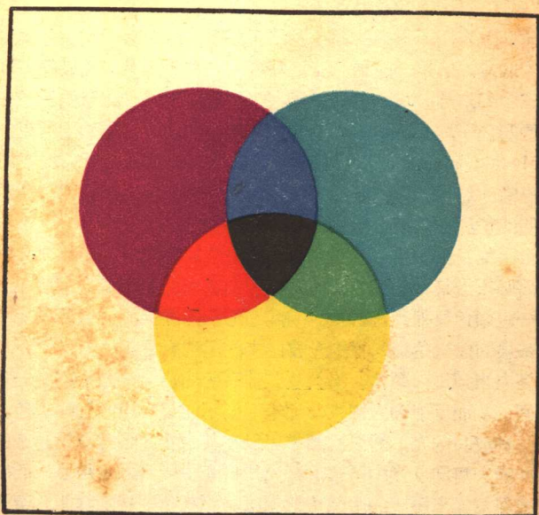
第4图 减色混合法的原理
