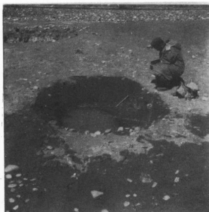
38. 虾拉沱索桥处鲜水河滩上出现巨大的喷沙冒水孔。
