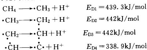
而甲烷分子中C—H键的键能则是 $(439.3 + 442 + 442 + 338.9)/4 = 415.5$  (kJ/mol)。键能可作为衡量共价键牢固程度的键参数，键能越大，说明键越牢固。
