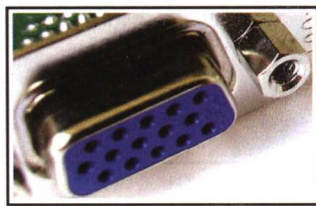
■ VGA 接口与显示器相连接输出模拟信号
