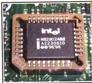
■ CMOS 是主板上的一块可读写 RAM 芯片，存有与该主板搭配的基本输入输出系统程序，用来保存 BIOS 的硬件配置和用户对某些参数的设定。
