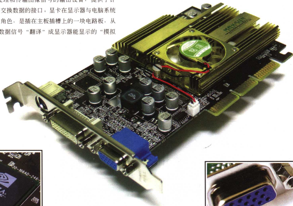
■ 显示芯片是显卡的核心部件，进行大多数图形运算
