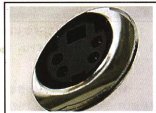
■ S-Video(S端子，二分量视频接口)用来将亮度和色度分离输出
