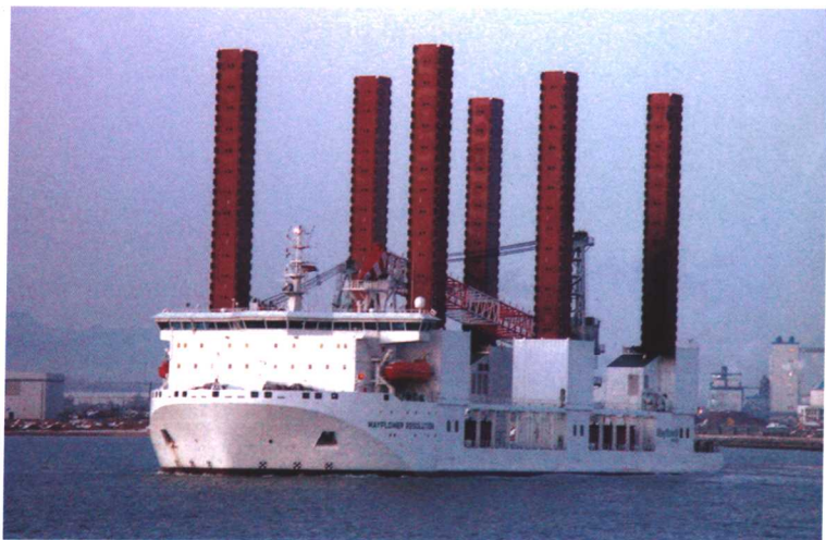
山海关船厂建造的第一艘 海洋风车安装船“五月花信念”号
