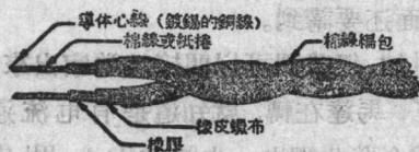
圖3 电灯用的花線,最裏面的心線是導體,外面的橡膠和包布是絕緣体
