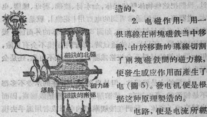
圖5 發電机的原理
