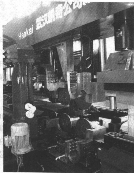
图 1-16 500 \text{ kV} \cdot \text{A} 的汽车燃油箱缝焊机
