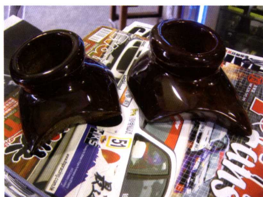
高音扬声器托架的桃木工艺 (2)
