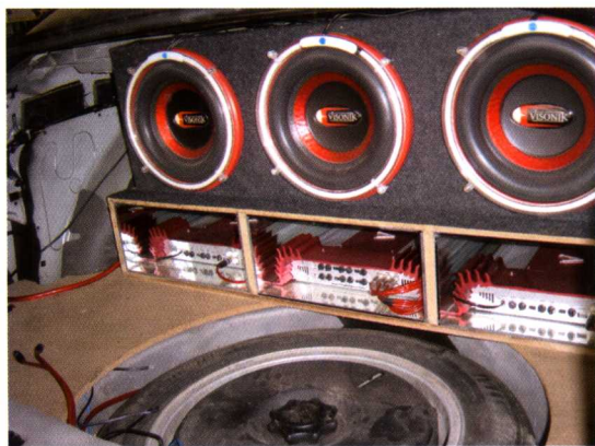
功率放大器及低音箱的安装部位
