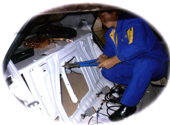
图 4-8 去除容易产生共振的部分
