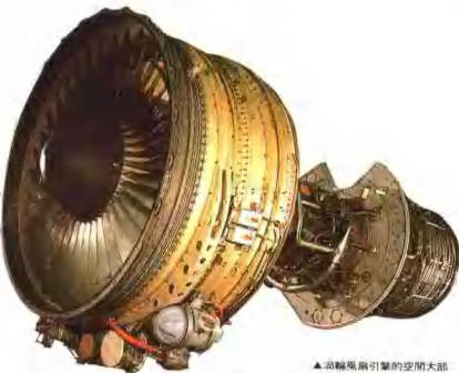
▲渦輪風扇引擎的空間大部分被巨型風扇所占用。當它以此高速度地飛行時，要比其他的設計具有更佳的性能。此外，它在起飛和爬升時亦能提供強大的推力。
