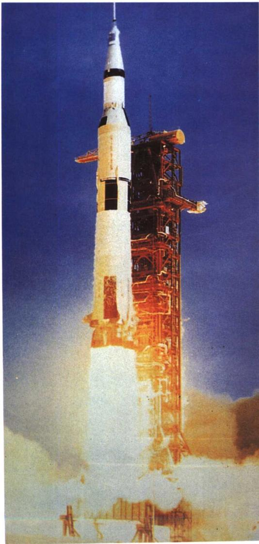
“土星”号巨型登月火箭是美国60年代初提出登月设想后的产品，其总设计师就是大名鼎鼎的布劳恩。从1964年至1967年，共研制成功土星1、土星1B、土星5等几种型号。图为“土星”5号运载火箭。1964年研制成功的“土星”1号两级火箭长38.1米，直径5.58米，发射重量502吨，近地轨道的有效载荷为10.2吨。1966年研制成功的反型型1B号两级火箭长85.6米，直径10.1米，起飞重量2950吨，近地轨道有效载荷为47吨，曾6次将“阿波罗”载人飞船送上月球。
