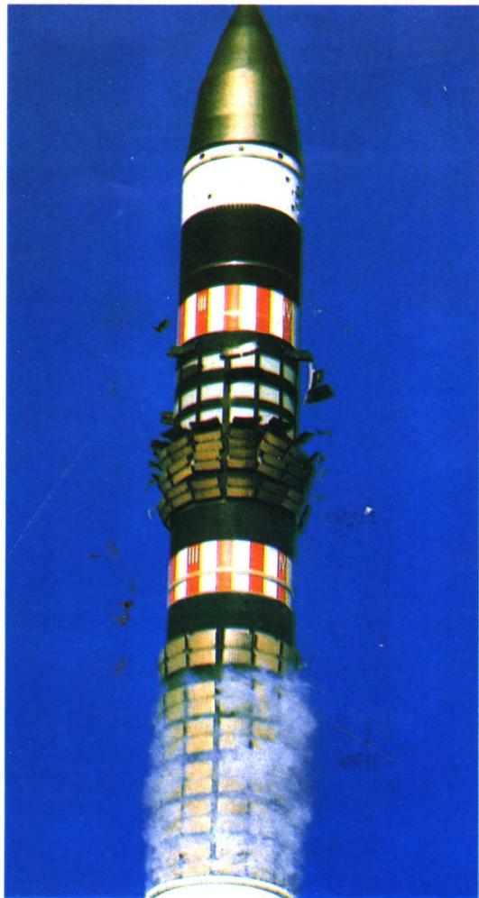
在美俄第地次《削减战略武器谅解协议》中，仍是美国将继续保留下来的陆基战略导弹。该导弹采用3级固体火箭发动机和液体火箭来助推发动机，惯性制导。2578千克的战斗部可装10个50万吨级TNT当量的分导核弹头，可按不同弹道分别命中目标。该导弹最大射程11100千米，命中精度为90—120米。弹长21.6米，弹径2.34米，发射质量86.4吨，可以采用地下井固定发射，也可以机动发射。
