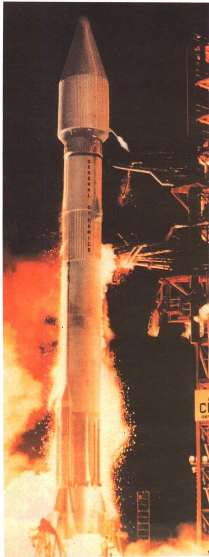
“宇宙神”系列运载火箭是美国通用动力公司生产的一种大型系列运载火箭，已连续生产四十多年。该火箭长25.1米，直径3米，起飞重量120吨。目前经常使用的是“宇宙神—阿金纳D”号和“宇宙神—半人马座”号两种型号。前者重129吨，能把2吨重的有效载荷送入500千米高的地球轨道；后者重139吨，近地轨道的最大运载能力为4吨。它们除作为“月球”号和“火星”号星际探测器的运载工具外，曾用来发射过通信卫星和“水星”号载人飞船。自1959年以来，已发射500多次，是使用最广泛的一种运载工具。
