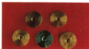
图十二 人工生长的金刚石制成的拉丝成品模。
