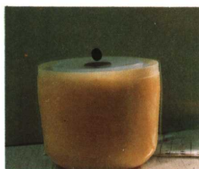
图十一 在液态氮温度下使永磁体悬浮。
