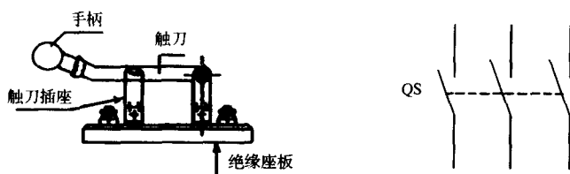
图 1.1 刀开关结构示意图和符号
