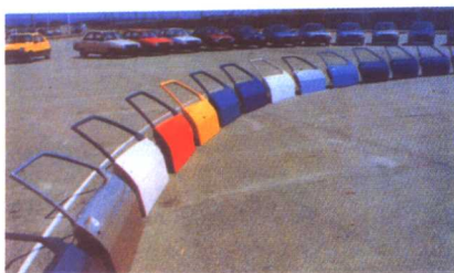
彩图 60 把油漆喷涂在零部件上和车身上进行对比试验
