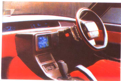
彩图 38 配备卫星导航系统和电子地图的操纵台
