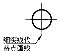
图1-11 较小的图形中的细点画线画法
