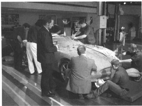
图1-3 国外某汽车设计,设计人员能够亲自参与设计的油泥模型制作,对完善设计方案的作用有着实际意义
