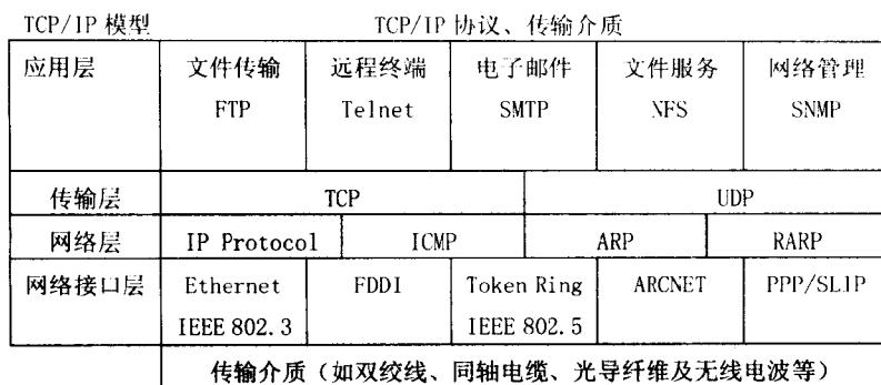
图 1-1 TCP/IP 协议模型
