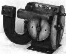
▲瓦特於一七七二年所製造的測微器是以鋼製材料，黏板以鋼材製成。移動的黏板由螺旋齒推動，旋轉十九圈會前進一寸，較大的刻度盤旋轉五十一圈會前進一寸。刻度細分至0.001吋。
