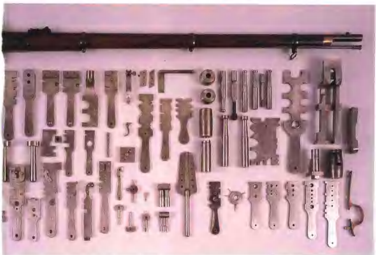
▼一八五三年製造皇家英菲爾德(Royal Enfield)步槍的各種量規。這種步槍是十九世紀後半期英國的制式步槍。
