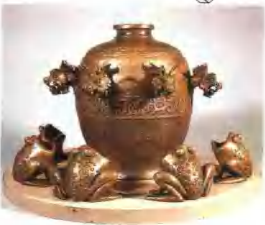
▲中國的張衡（西元二世紀）建造了地動儀(seismoscope)來偵測地震。重物以這樣懸掛在瓶內。當地震的震波使重物搖擺時，由於連桿的帶動，瓶外在搖擺方向的龍嘴會打開，一個球會掉入下面的槽裡。
