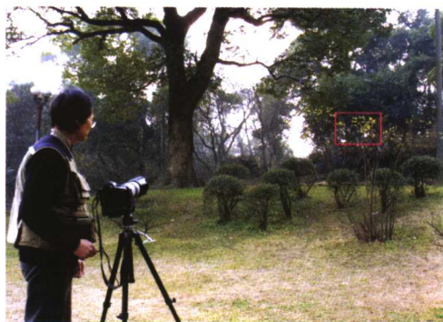
图1-8 35mm单反相机，长焦距镜头，架在三脚架上，用快门线控制拍摄。方框内是所取的画面。
