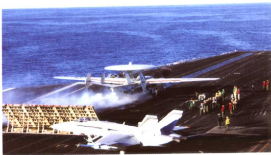
美国航母MK7型导流板由6块水冷板面构成
