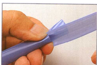
6 反向挤压，将折角弹开，卡住嵌紧。
