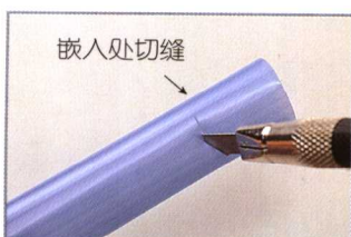
4 取一圆管，用刀笔划出一道切缝(须小于嵌入角)。
