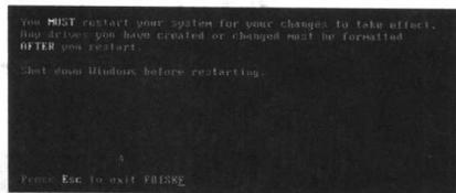
按 Esc 快捷键退回到 DOS 模式后，同时按 Ctrl+Alt+Delete 组合键重新启动计算机，用 Windows 98 启动软盘引导计算机进入 DOS 模式，在提示符状态下分别格式化各个分区。
