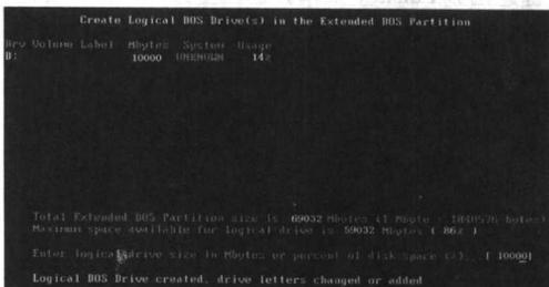
输入第二个逻辑分区的大小 10000 并回车确认。继续划分剩余的逻辑分区为 E、F、G、H，按 Esc 快捷键退回 Fdisk 主菜单。然后要激活主分区以使该分区能够引导系统，输入“2”并回车确认，出现如下界面：
