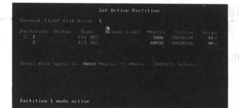
按 Esc 快捷键两次，退出 Fdisk 程序，将出现如下图所示的提示，提醒你重新启动系统以使分区生效。
