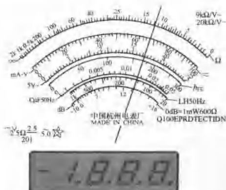
图 1-1 指针显示和数字显示
