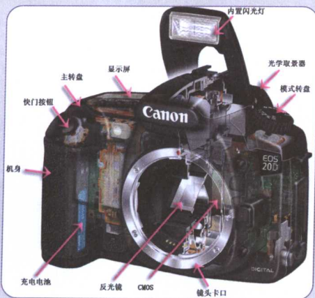
图1.1 Canon EOS 20D 数码相机的结构
