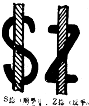
图1 纱线的捻向图
