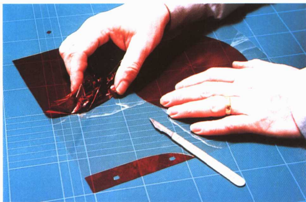
刀刻胶片。必须注意不要刻透到下面的塑料底板。
