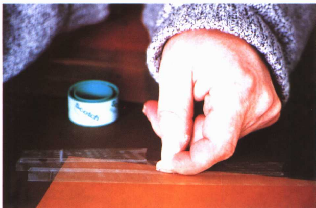
透明胶带。这是临时的漏版，要摩擦才能牢固地贴在干燥的网版上。
